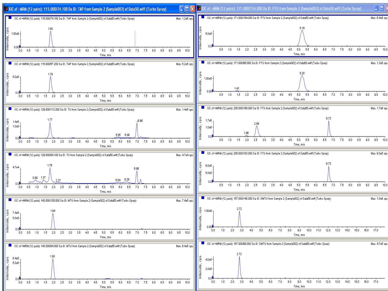
Ryc.1. Chromatogram MRM z ekstraktu mięśni bydła, wzmacnienie matrycy tyreostatykami 5 µg/kg MRM chromatograms of bovine muscle extract, spiked matrix thyreostats 5 µg/kg
