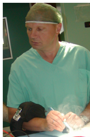
Ryc. 4. Pomiar prądu indukowanego w przedramieniu chirurga przy zastosowaniu miernika indukcyjnego The measurement of the current induced in the surgeon's forearm by the use of induction meter
